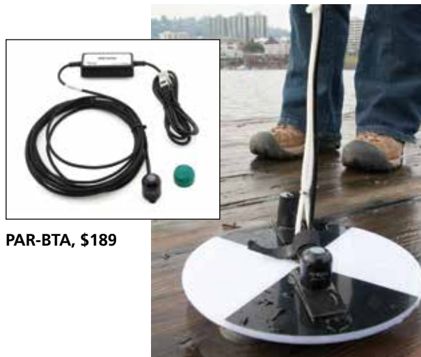
PAR Sensor mounted on a Secchi disk
